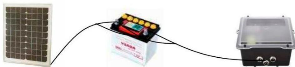
Per posizionare il dispositivo con un pannello solare, è necessario collegare i morsetti del pannello (quello rosso al positivo e quello nero al negativo) nella batteria e dalla batteria rimuovere il cavo che andrà al repeller.
