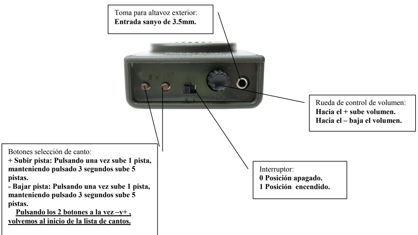
Este reproductor digital de sonido funciona a 12 voltios o con una pila de 9 voltios **6LR61 ALCALINA**.
