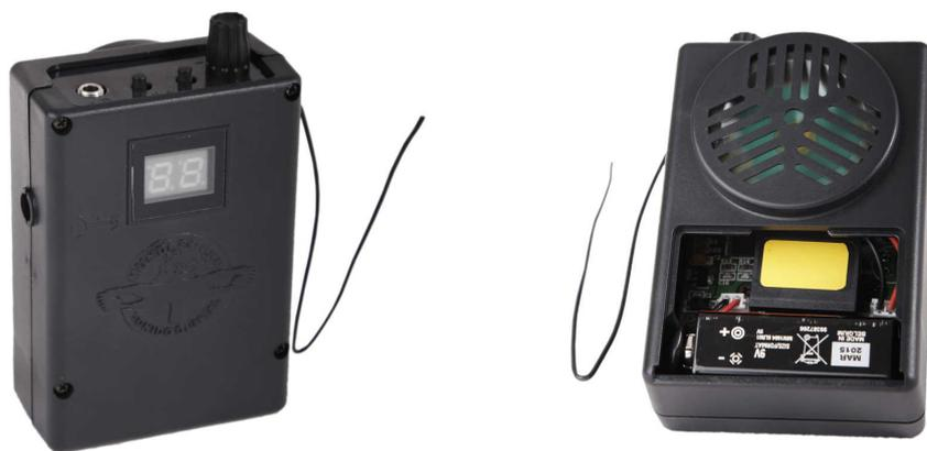
**Imagen derecha: Vista trasera del aparato donde está el display para ver el número de canto que se reproduce (se desconecta a los 15 segundos).**
