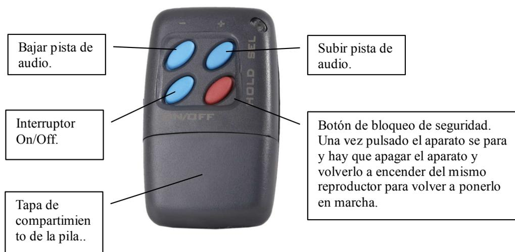
Este reproductor digital de sonido funciona a 12 voltios o con una pila de 9 voltios 6LR61 ALCALINA.
